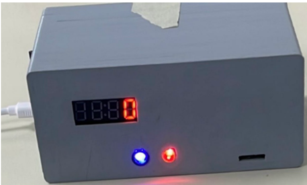
FIGURA 2. Vista externa del dispositivo con el sensor lumínico activo y la pantalla de registro
