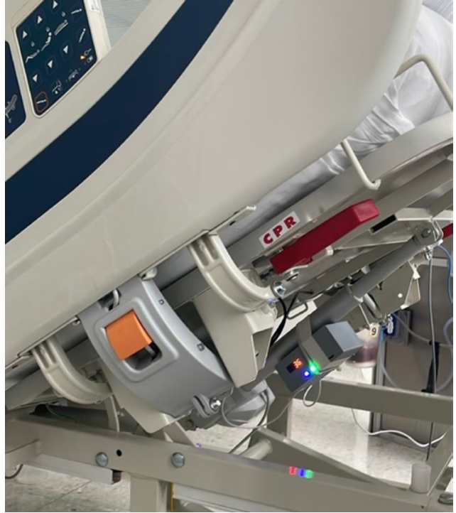
FIGURA 3 Dispositivo inclinómetro instalado con sensor lumínico activo y pantalla con registro en la cabecera de una cama
